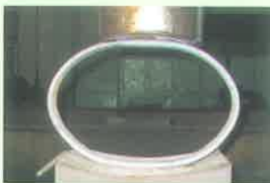
压扁试验 Ring test
